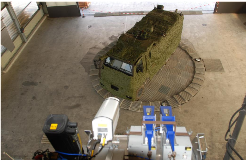
Des antennes radar (au premier plan) mesurent un GMTF doté d'un dispositif de camouflage monté sur une plaque tournante.
