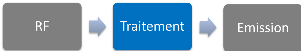
Figure 1: représentation abstraite de la structure d'un système radio générique
