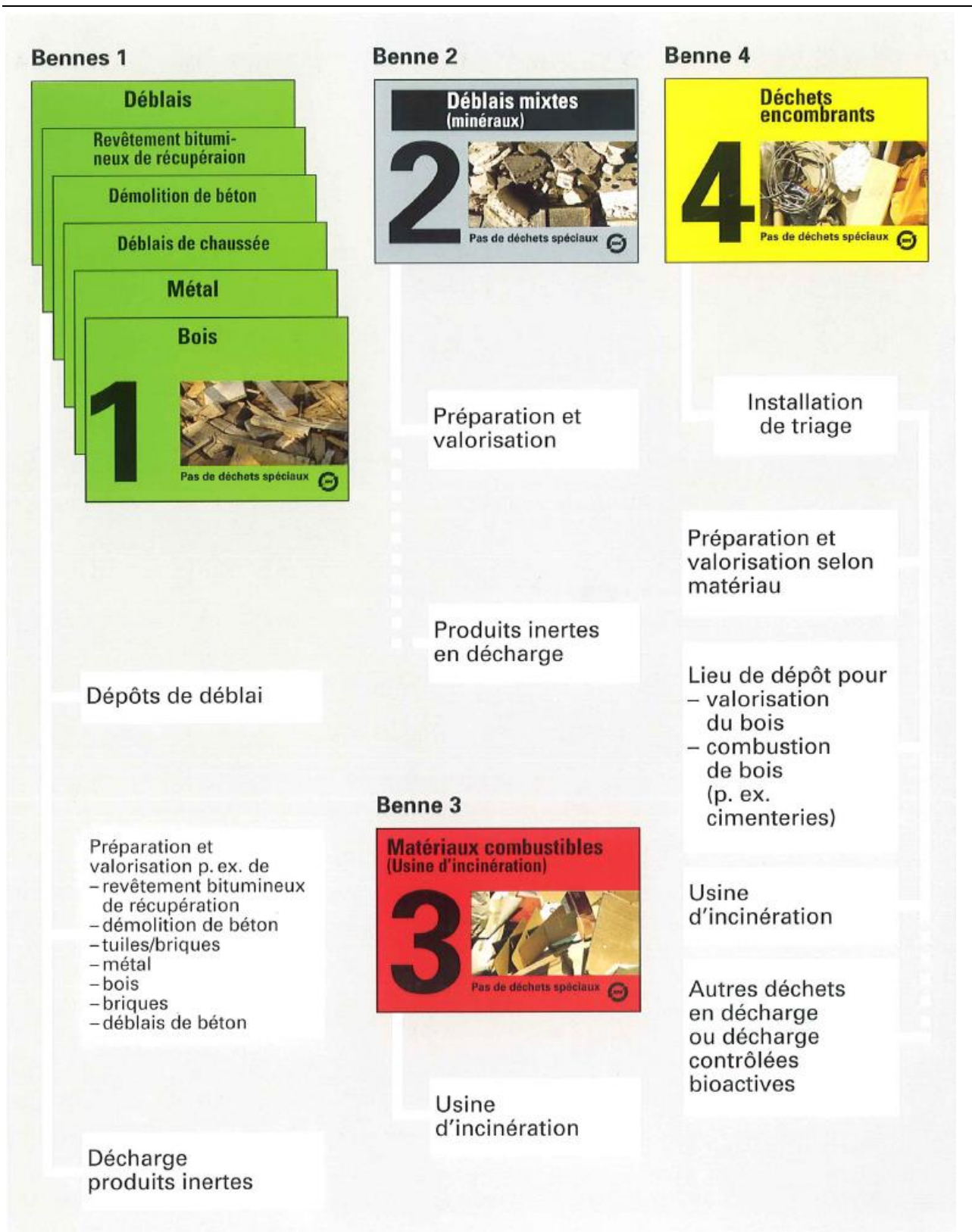
Figure 5: Concept des bennes multiples Le chantier doit être organisé de telle manière que les déchets puissent être traités sur place et collectés dans des bennes ne contenant qu'un type de matériau (benne 1).
