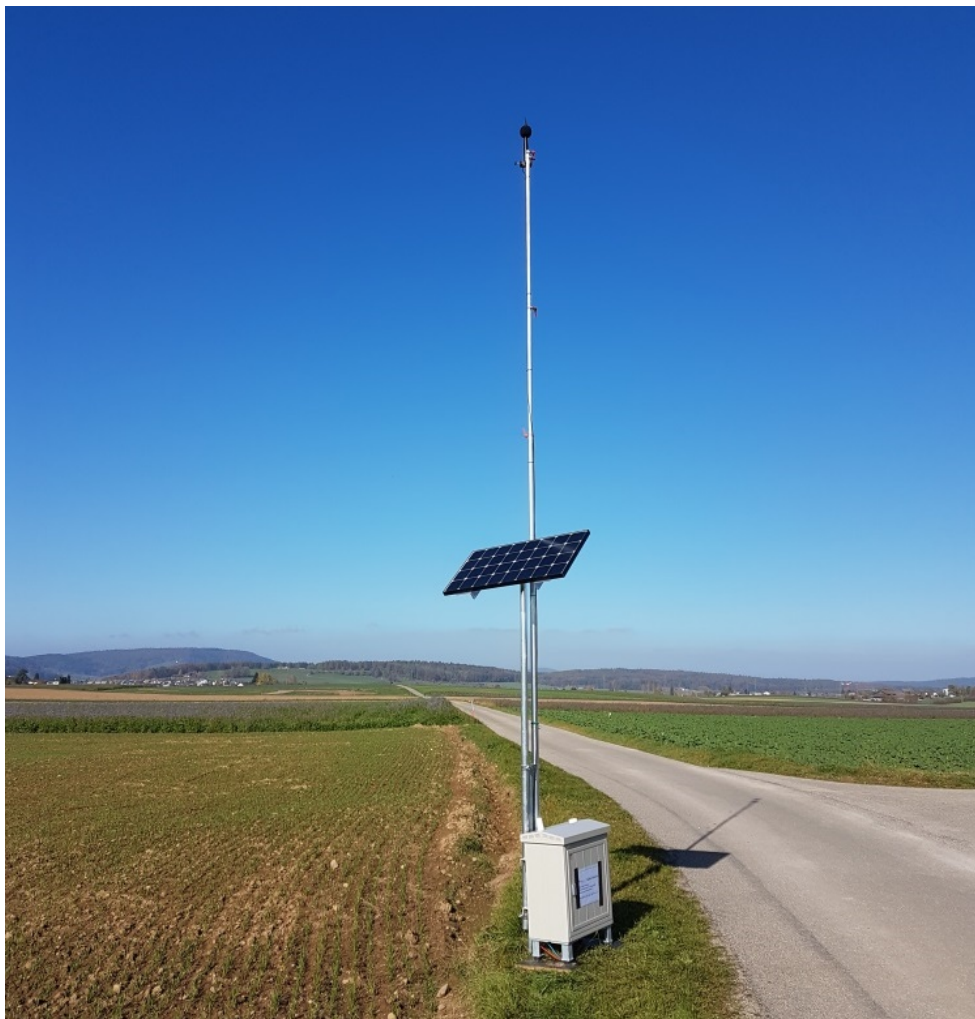
Figura 2: Esempio di stazione costituita da microfono, pannello solare e armadio per gli strumenti di misurazione (© Empa)
