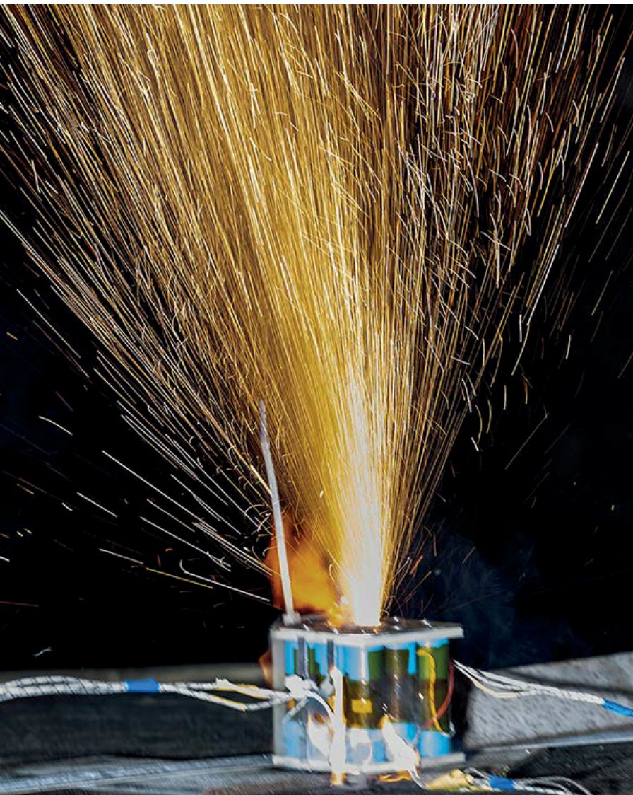
Ausschnitt des Resultats durch das Aufheizen einer 4.9 Ah Lithium-Nickel-Kobalt-Oxid (NCA) Zelle eines Akkumodules.
