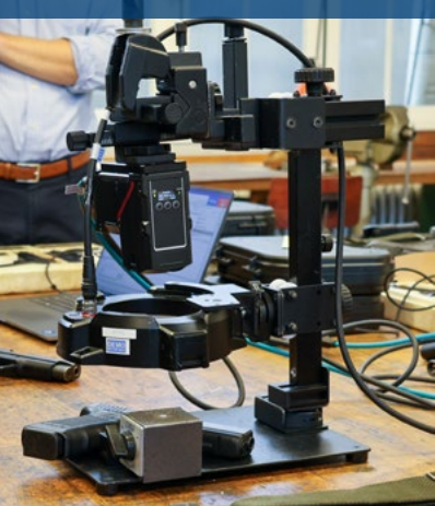
Das Testsystem zum automatischen Einlesen der Waffen-Seriennummern.
