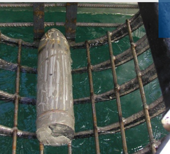
Probeweise Hebung einer Granate mit Spezialgreifer bei einer früheren Untersuchung im Vierwaldstättersee.
