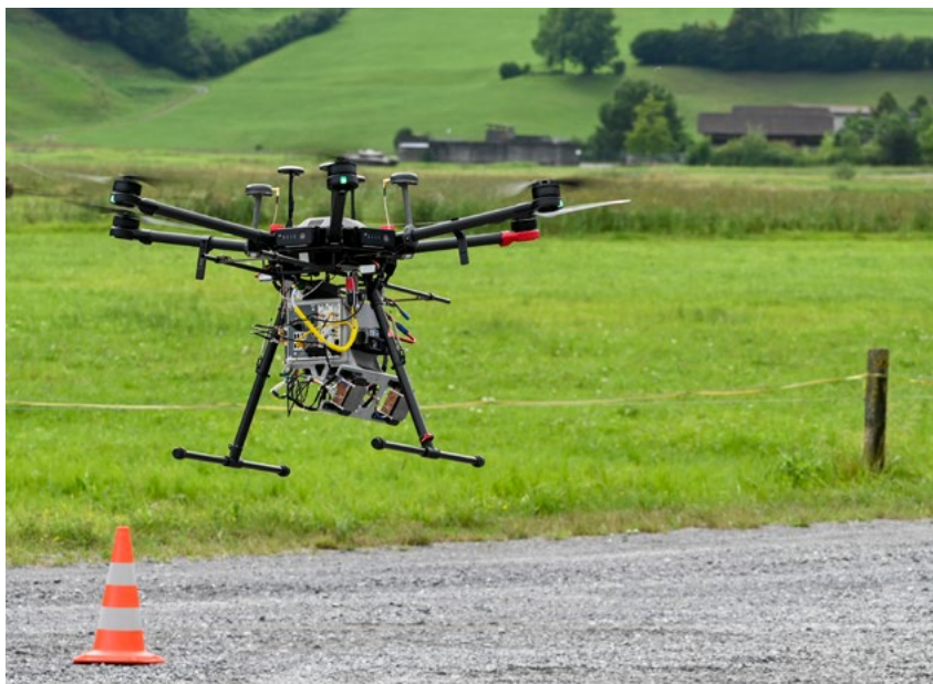
Eine Drohne mit einem SAR-System unterhalb montiert.
