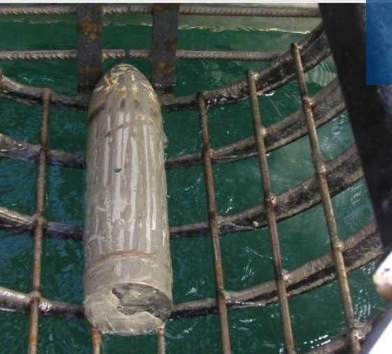
Essai de remontée à la surface d'un obus à l'aide d'un grappin spécial lors d'une investigation dans le lac des Quatre-Cantons.
