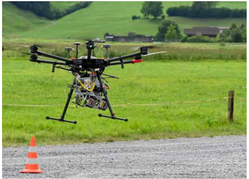
Gros plan sur un drone avec un système SAR monté en dessous.
