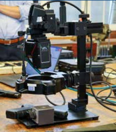
Le système de test pour la lecture automatisée des numéros de série des armes.
