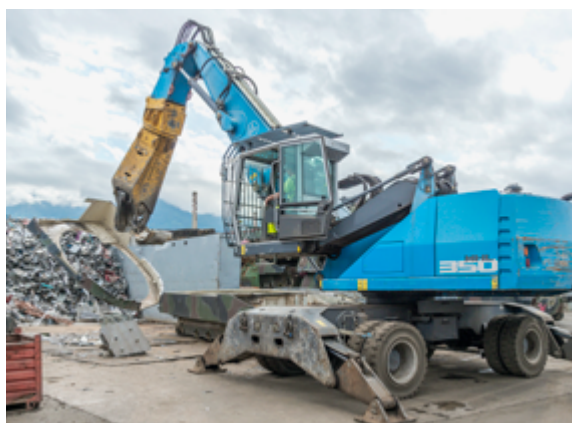
Einsatz der Hydraulik-Schere.
