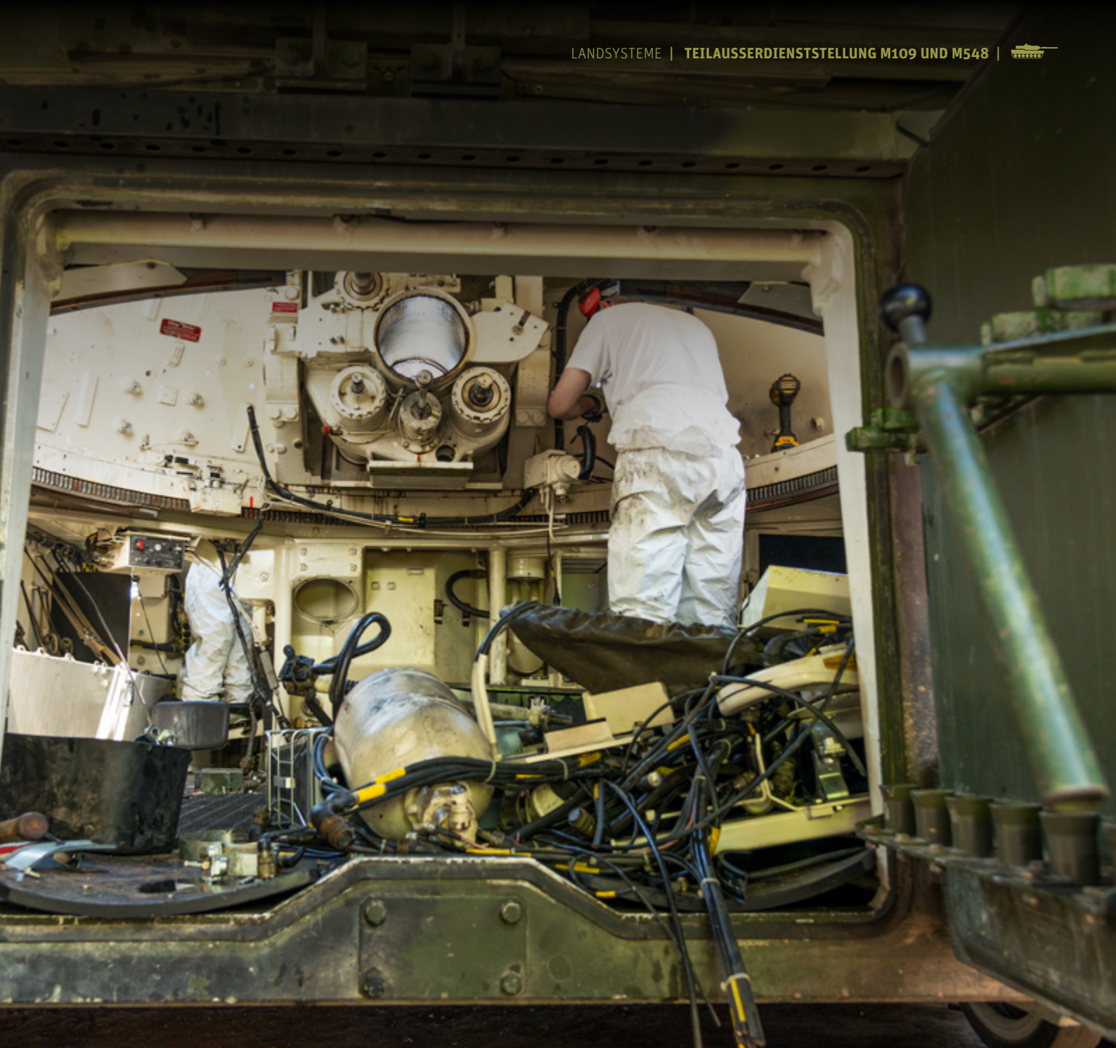
Demontagearbeiten im Innenraum der Panzerhaubitze.
