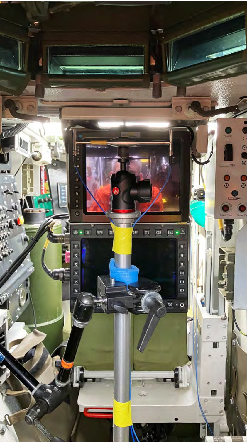
Montage expérimental pour la mesure de la pression d'explosion : des microphones sont installés à la position du chef de pièce pour mesurer la pression d'explosion.
