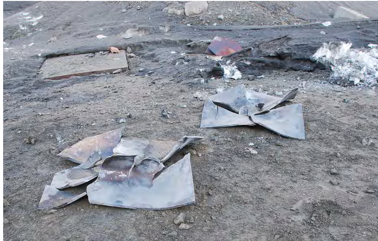
Morceaux de panneaux recueillis après l'explosion. Ils se trouvaient à une distance maximale de 40 m. Les blocs de béton, qui pèsent 600 kg chacun, ont été déplacés d'une dizaine de mètres par la détonation.
