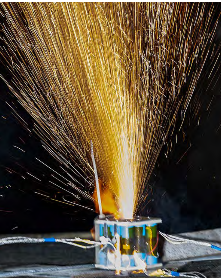
Extrait du résultat obtenu par échauffement d'une cellule lithium-nickel-oxyde de cobalt (NCA) de 4,9 Ah d'un module d'accumulateur.
