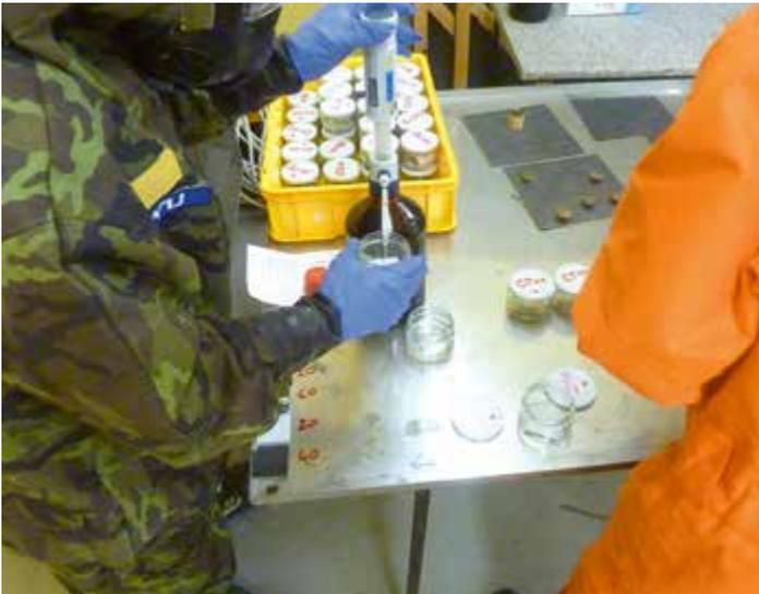
Vorbereitung der Extraktionsgefäße mittels Dosierung (des Extraktionsmittels).
