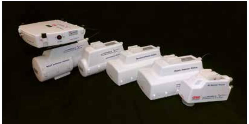
Damit wird die Strahlung gemessen und lokalisiert: Die NUVIA Tech- Ausrüstung besteht aus einem Basis- und Kommunikationsmodul, je einem grossen und einem kleinen Natriumiodid-Detektor, einem Neutronen-Detektor, einem Plastiksintillator und einem Air Sampler (v.l.n.r.).
