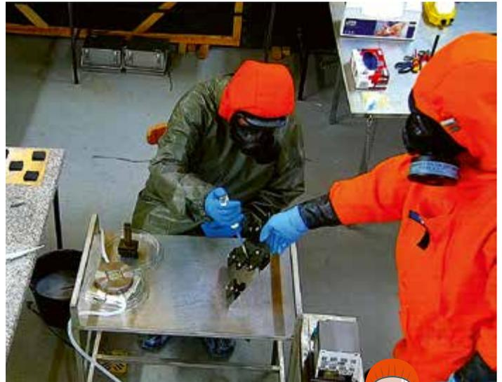
Kontamination der Proben erfolgt mittels Stempel oder Pipette, wie hier einer stack Probe.
