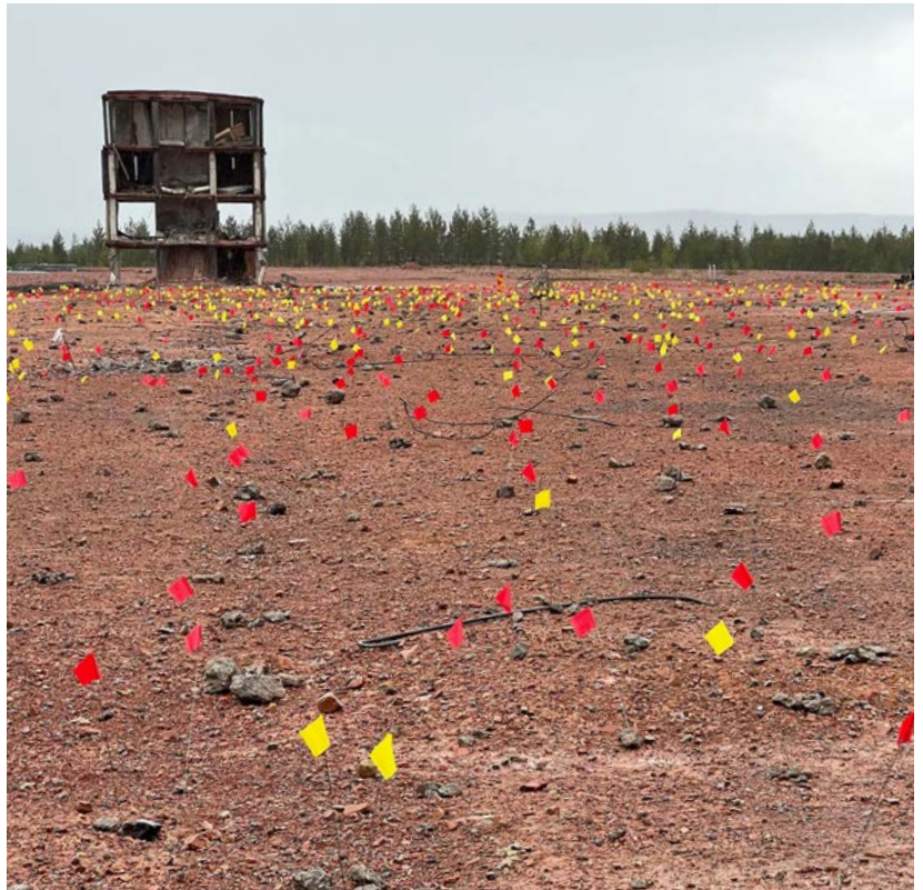
Durch die Explosion entsteht im Frontbereich des Munitionsmagazins ein Trümmerfeld. Bei der «Pick-up-Phase» wurden die mehreren tausend Trümmerteile von Hand farblich markiert, gewogen und letztlich aufgesammelt und entsorgt.
