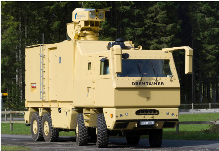
Figure 4: Démonstrateur du système laser mobile de 20 kW de Rheinmetall. On notera, sur le toit du véhicule, la tourelle avec télescopes pour deux lasers de 10 kW.
