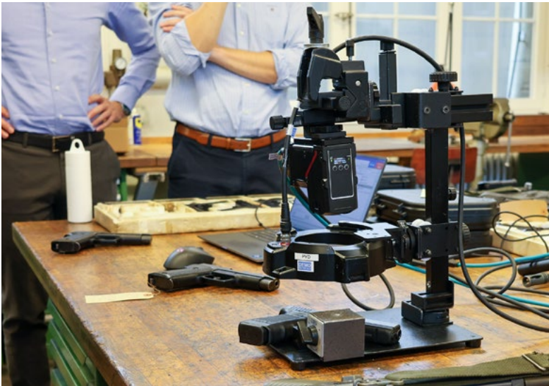
Un système pour la lecture automatisée des numéros de série des armes à l'essai
