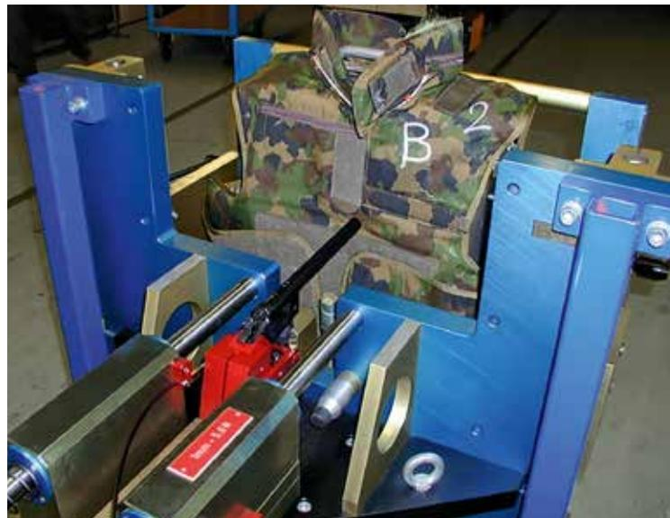
Die aufgesetzte Waffe (Kaliber 9mm) wird mit einem genau definierten Anpressdruck auf dem Prüfobjekt positioniert.
