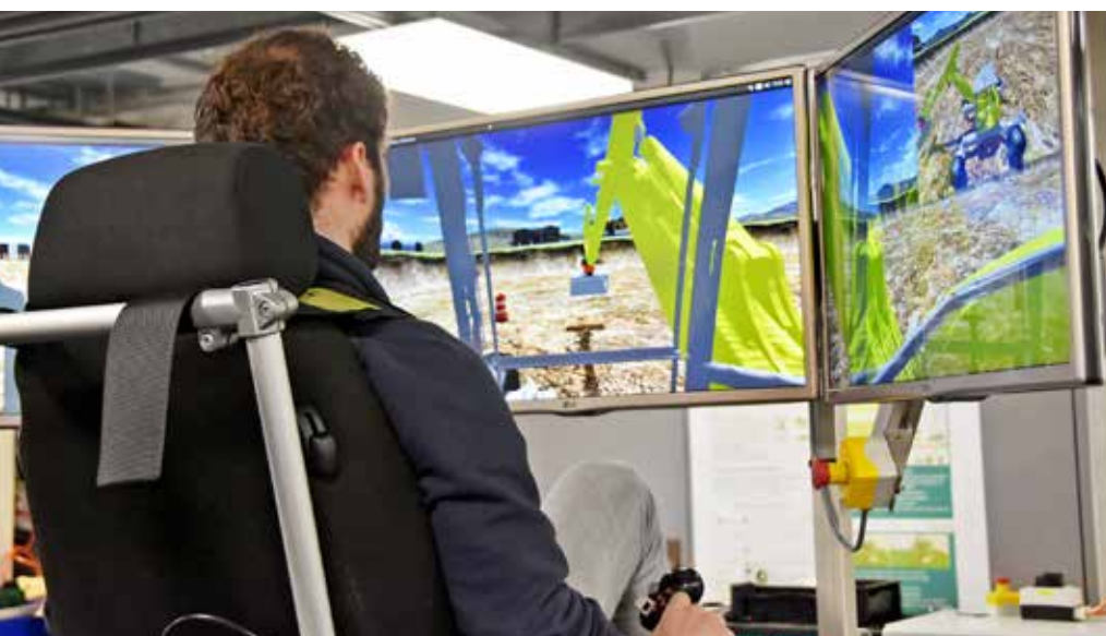
Cockpit zur Fernsteuerung einer hochmobilen Mehrzweckmaschine.
