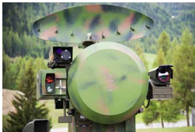
Richtgerät des Flt Gt 75/10 mit Suchradar, Folgeradar, TV-Kamera und IR-Kamera.
