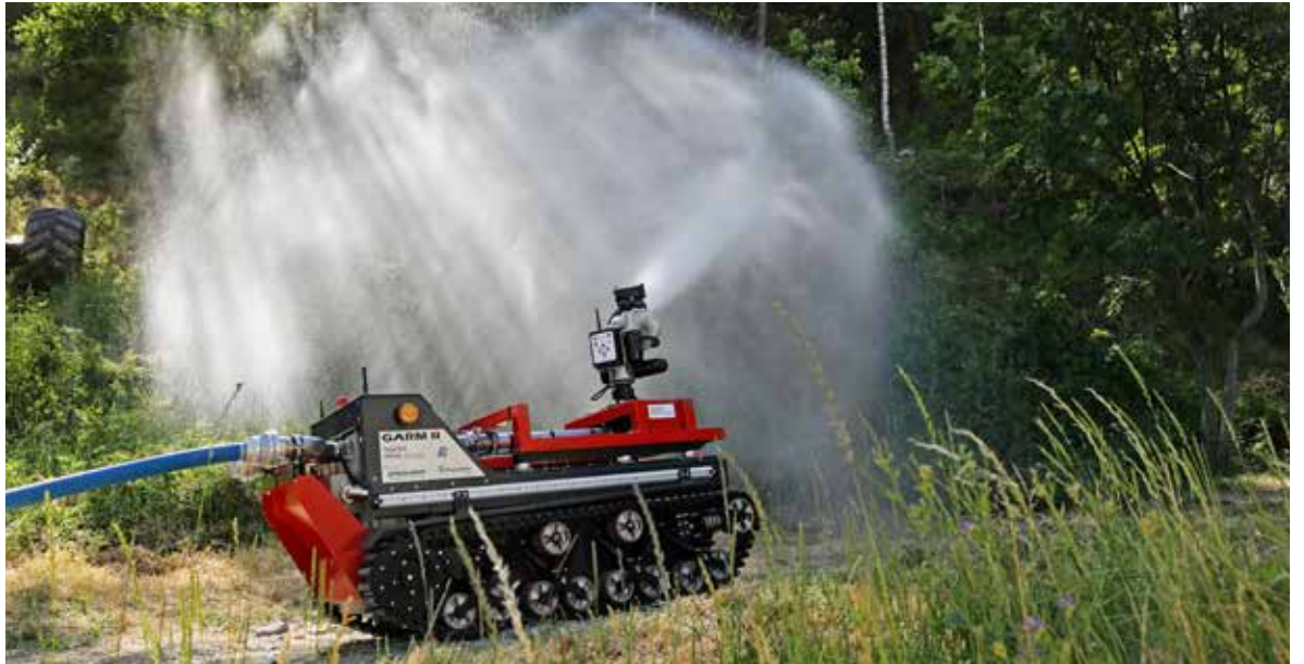
Forschungsdemonstrator zur Unterstützung bei Brandbekämpfung.
