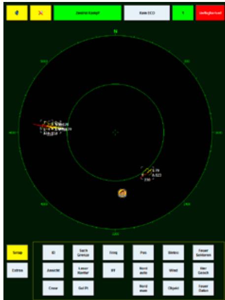
Bedieneinheit Feuerleitgerät – Oben Status Feuerleitgerät, Mitte Local Air Picture, unten Bedien-Funktionen.
