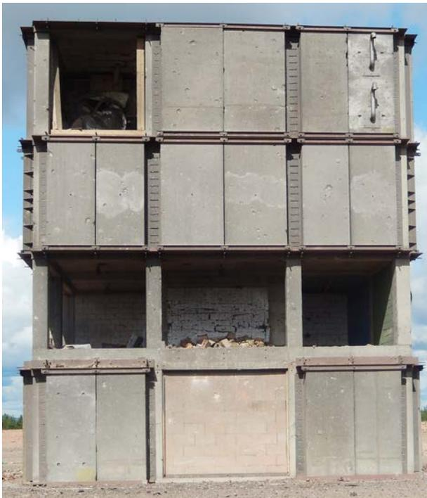
Die verschiedenen schweizerischen Mauerwerkstypen im ersten Stock des Testobjekts wurden von der Druckwelle – wie erwartet – komplett zerstört.
