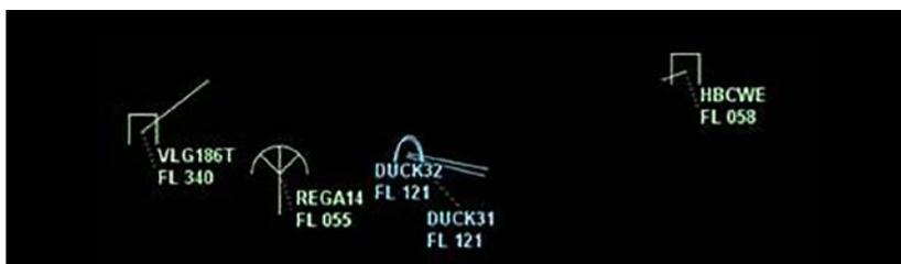
Abbildung 2: Darstellung von sogenannten «Tracks» im System MILVE mit Informationen zu Identifikation, Richtung, Callsign und Flughöhe der Luftfahrzeuge.
