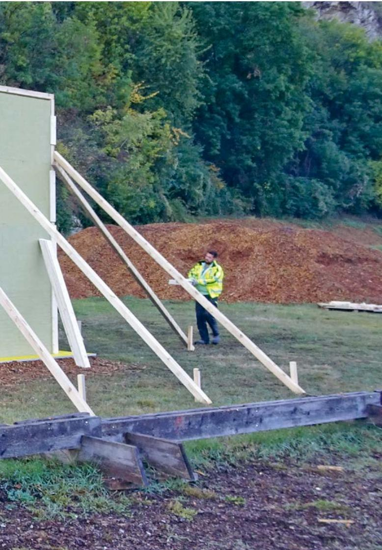
Die experimentelle Rasterdeckenanlage auf dem Schiessplatz Pra Bardy ist vier Meter hoch, vier Meter breit und zwölf Meter lang. Die Wände bestehen aus vertikalen Holzstreben und Mineralwollmatten. Die Decke besteht aus Leichtmetalllamellen und aus Mineralwollmatten.
