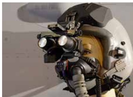
Im Helm integriertes Nachtsichtgerät eines F/A-18 Piloten.
