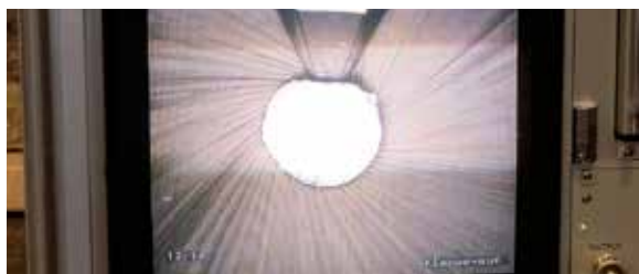
Das Steuergerät der Ladungsentfernungsanordnung (LEV) mit Monitor. Via Fernsteuerung wird die flache Bergungsvorrichtung (oben im Bildausschnitt) behutsam entlang des Rohres über die Ladung bis an ihr hinteres Ende geschoben. Mit einem schwenkbaren Greifer, der auf der Rückseite der Ladung angesetzt wird, zieht man anschliessend die Ladung mitsamt der Bergungsvorrichtung aus dem Rohr.
