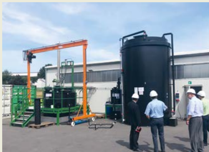
Aussenansicht der Anlage mit Salzsäuretank (rechts) sowie Reaktor, in welchem die MgTh Teile aufgelöst werden (links).
