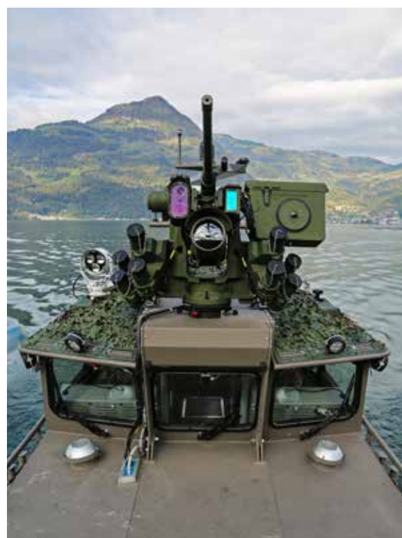
Auf dem Steuerhaus aufgebaute Waffenstation.
