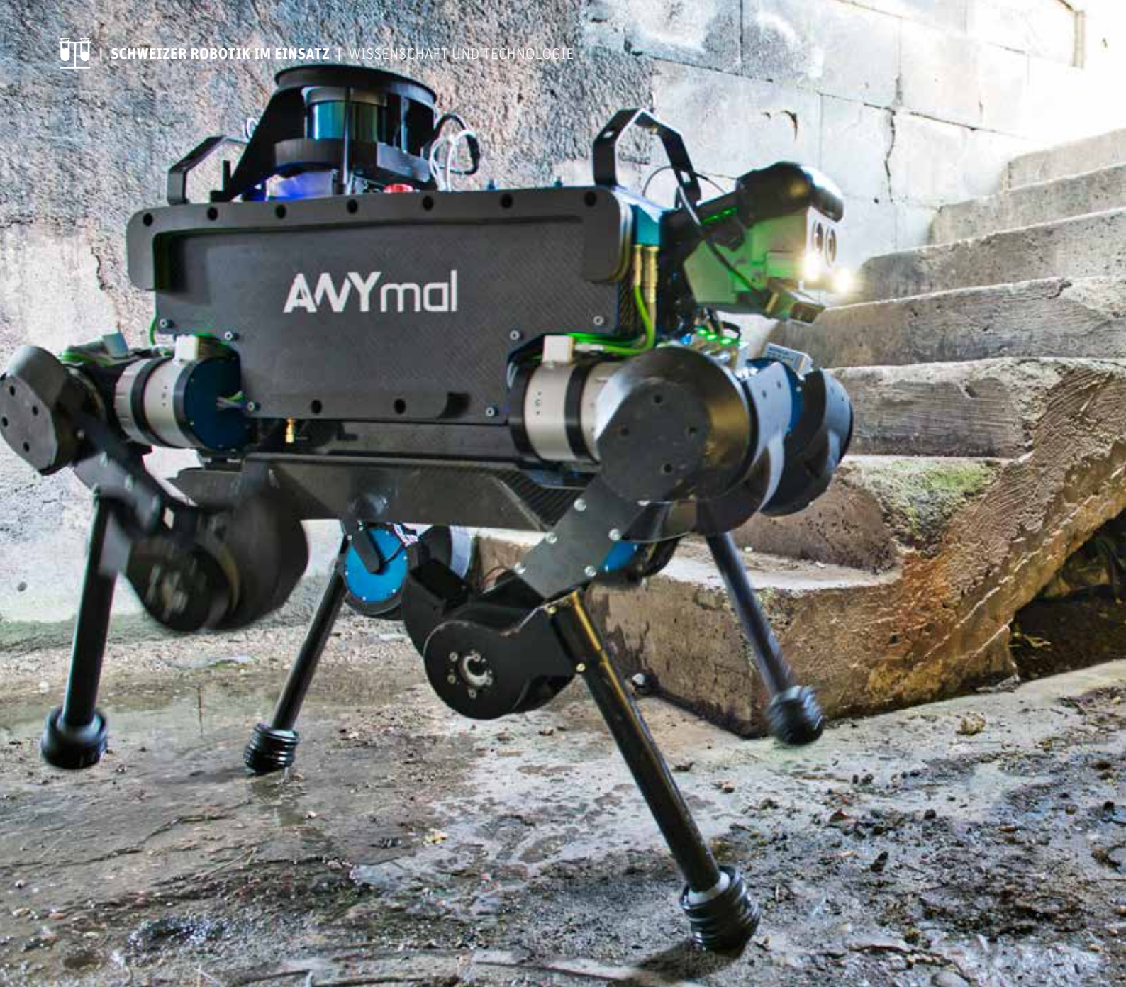
Prototyp eines vierbeinigen Roboters der ETH Zürich bei der simulierten Personensuche.
