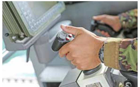
Arbeitsplatz des Bordschützen – Fire Control Unit für die Waffenstation RWS PROTECTOR M151.
