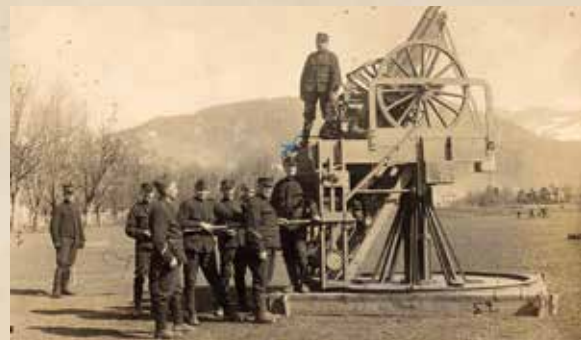
Gotthard-Kanone zur Fliegerabwehr auf einem Drehpodest, zusammen mit der Mannschaft.
