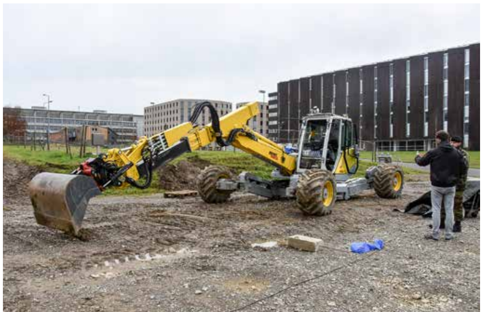
Fernsteuerbare Mehrzweckmaschine mit automatisiertem Unterwagen zur Untersuchung verschiedener Anwendungen im Bereich der Katastrophenhilfe.
