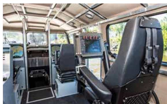
Blick ins Steuerhaus mit den Arbeitsplätzen (v.l.n.r.) des Kommandanten, des Navigators, des Schiffführers und des Bordschützen (Musterboot).
