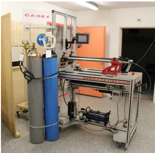
Fig. 2: impianto di prova per l'accelerazione di piccole schegge
