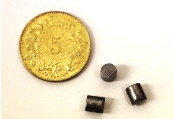
Fig. 1: fragment simulating projectiles FSP con massa di 0.325 g
