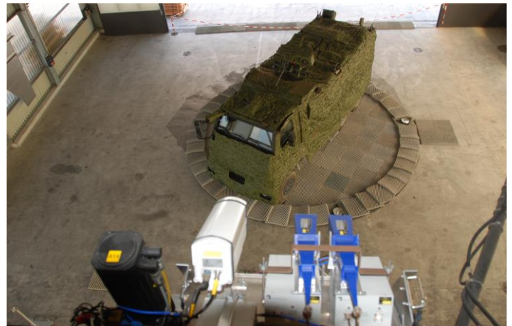
Le antenne radar (in primo piano) misurano il VTTP mimetizzato in rotazione
