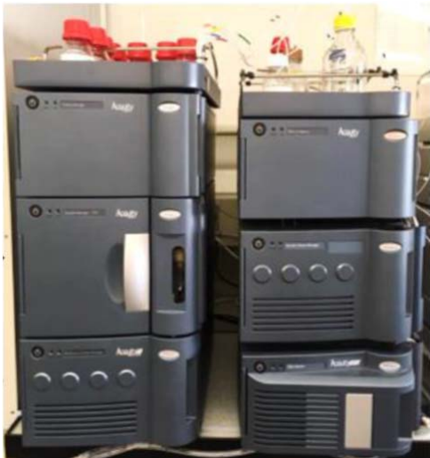
Ultra-high performance liquid chromatography (UHPLC) pour l'analyse des poudres pour armes au sein d'armasuisse S+T
