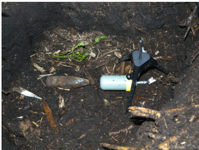
Fig. 2: Destruction sans contact de munitions non explosées (obus explosif 30mm canon pour avion)
