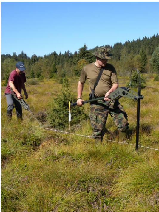
Fig. 1: Détection de munitions non explosées dans le sol
