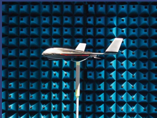
Abbildung 3: Messung des Radarrückstreuquerschnittes der Drohne Skywalker X-8 FPV in der echofreien Messkammer von armasuisse / Wissenschaft und Technologie © VBS/DDPS.
