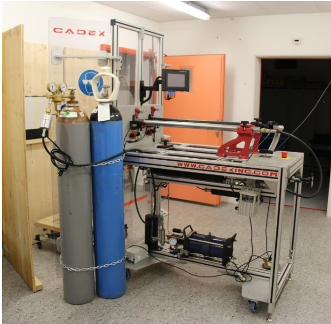
Bild 2: Prüfanlage zur Beschleunigung von Kleinstsplittern
