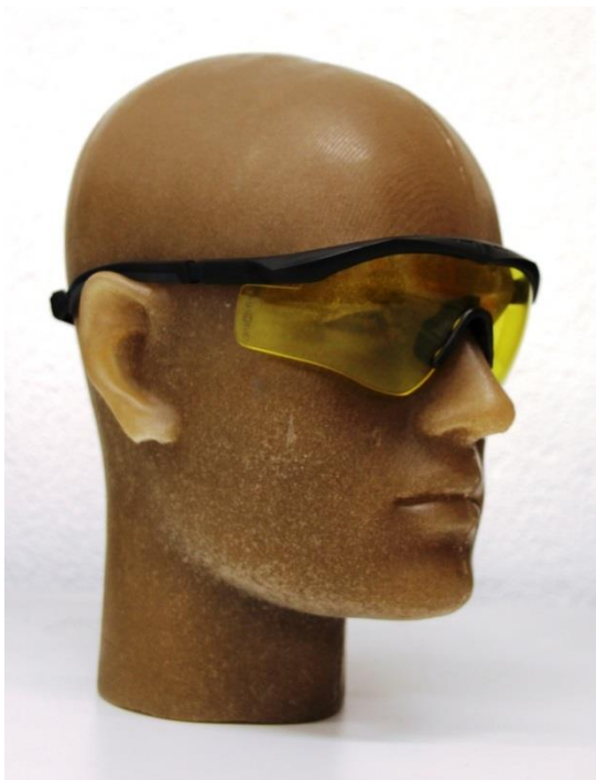
Bild 3: Kopfmodell aus Polyurethan
