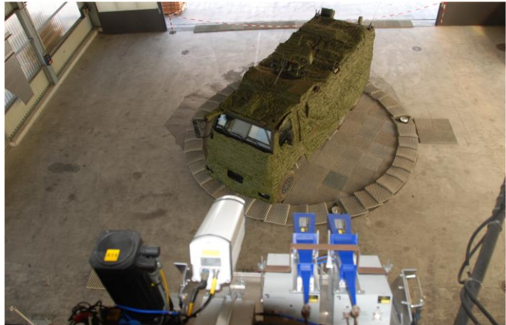
Radaranennen (im Vordergrund) messen rotierenden GMTF im Tarnkit
