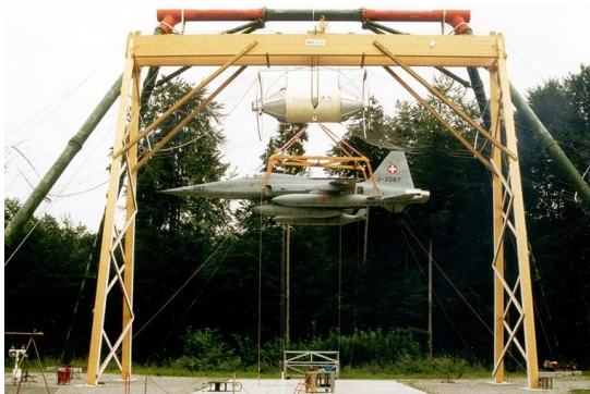
Abbildung: NEMP Prüfeinrichtung für den Tiger F-5 Test
