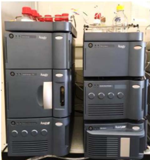
Ultra-high performance liquid chromatography (UHPLC) zur Analyse von Treibladungspulver bei armasuisse W+T
