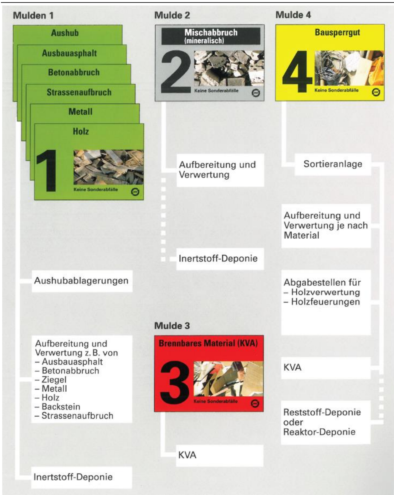
Figur 5: Mehrmuldenkonzept. Die Baustelle ist so zu organisieren, dass die Abfälle vor Ort getrennt und in Einstoffmulden (Mulde 1) gesammelt werden.
