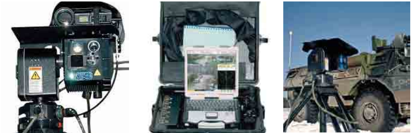
Exemple de système autonome. A gauche capteurs avec au dessus une caméra thermique. Au milieu : unité de commande et de visualisation. A droite : système monté sur trépied. [source : CILAS]
