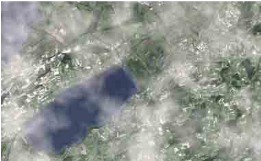
Das Programm arbeitet mit einer Bodenabdeckungsaufösung von 25 m. Dadurch lassen sich detaillierte Aussagen zu Störsignalen gewinnen. Zusätzlich können die Wetterdaten (hier im Beispiel Wolken) realitätsnah simuliert und ihre Auswirkung auf die Leistungsmerkmale von Radarsystemen untersucht werden.
