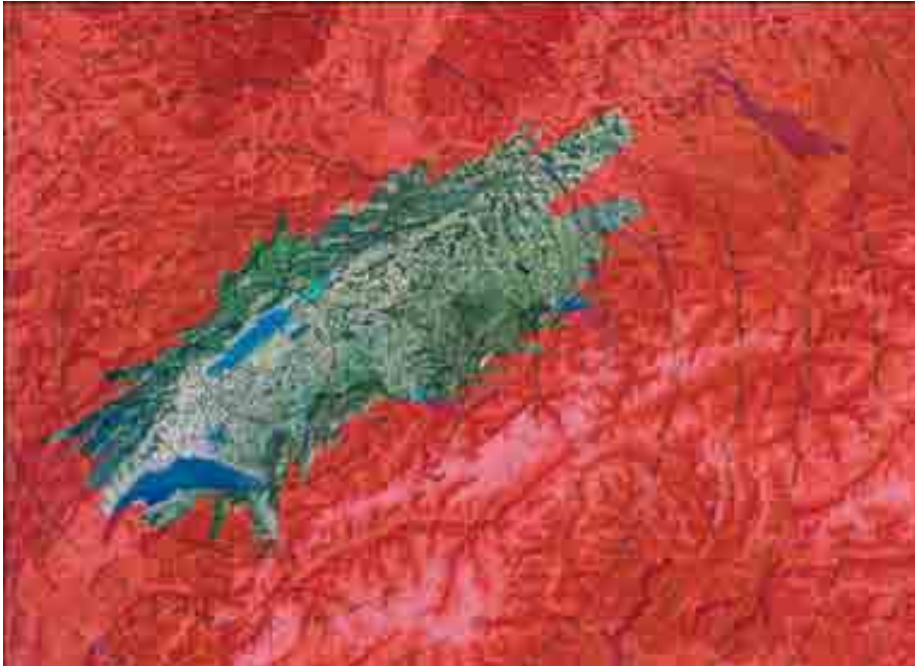
Berechnetes Sichtbarkeitsgebiet eines Radars mit Standort im Zentrum der Kreise. Das Radar kann ein Flugobjekt, das sich im roten Bereich befindet, nicht detektieren. Solche Sichtbarkeitsdaten lassen sich für beliebige Flughöhen angeben und berücksichtigen, dass das Gebirge das Radarsignal abschattet.
