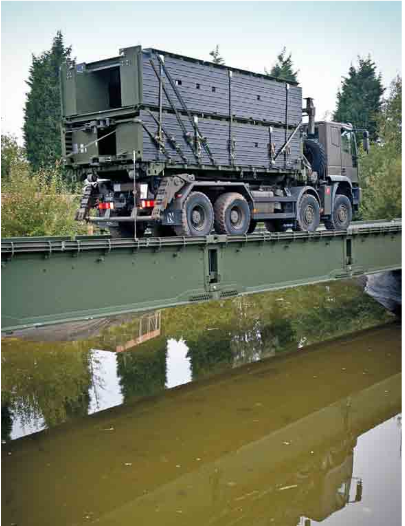
IVECO 8x8 mit zwei Brückenmodulen auf Wechselabrollbehälter beim Überqueren der Unterstützungsbrücke 45 m.
