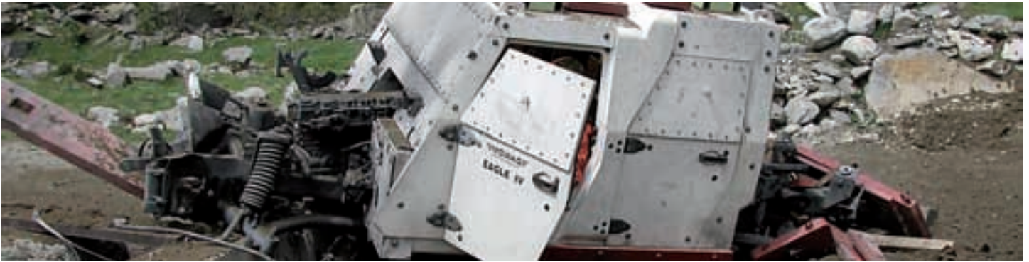
» Ergebnis einer Minensprengung unter dem linken vorderen Rad. Trotz weitgehender Zerstörung des Fahrzeuges hätten alle Insassen überlebt.
