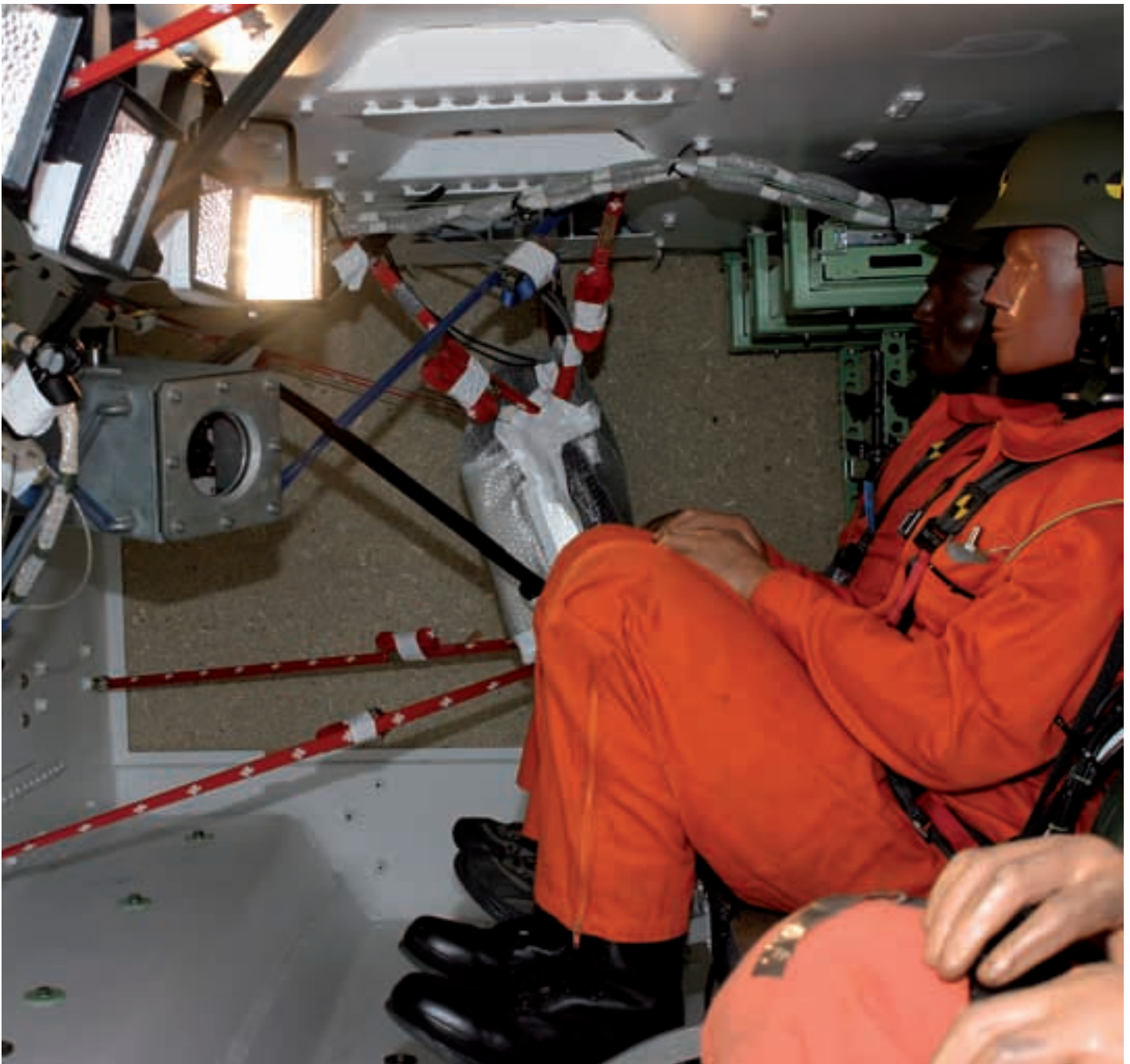
» Messeinrichtung in einem Versuchobjekt. Baugleiche Dummies werden auch in Crash-Tests verwendet.
