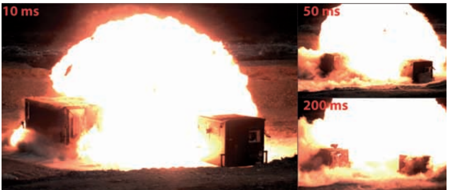
» Zeitlicher Ablauf einer Sprengung (etwa 80kg TNT 1m ab Boden). Zur Skala: der rechte Container misst 2.5 x 2.2 x 2.2m (l x b x h).
